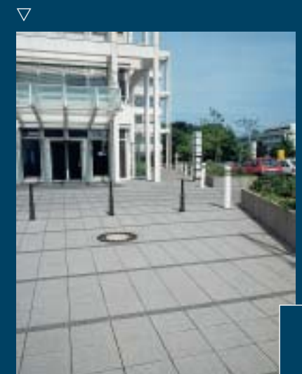
Platten 40 x 40 cm rinnit Granit, Quadratpflaster 10 x 10 cm rinnit Basalt
